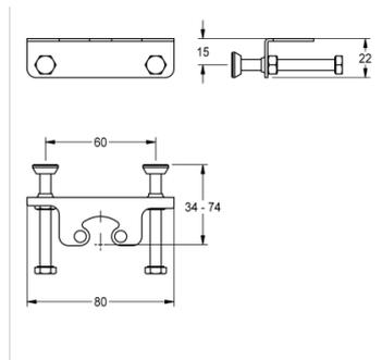
Verdrehsicherung für F5L-Mix Einhebel-Standatterie, nicht kombinierbar mit Hygieneinheit.
